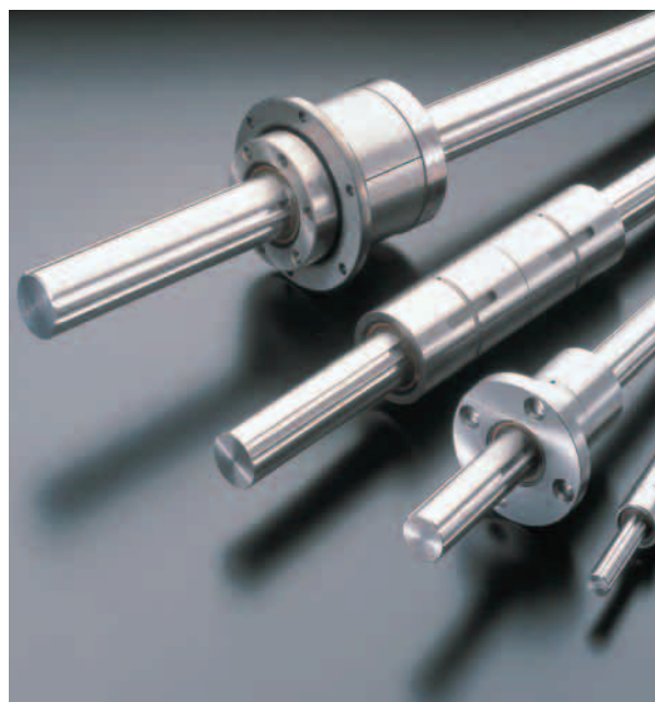
ボールスプラインは、精密研削されたスプライン軸の転動面を、スプラインナットに組み込まれたボールが滑らかな直線運動をしながらトルク伝達ができる直動システムです。
