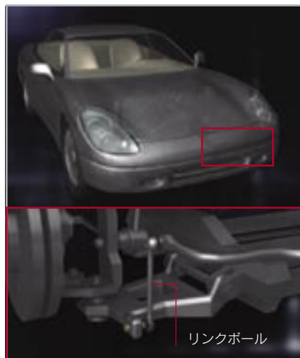
リンクボールの使用例 (自動車)
