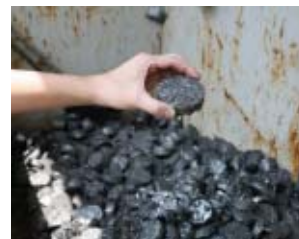
▲固形化した研削スラッジ
