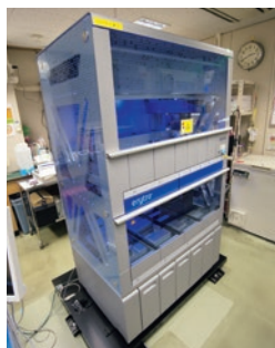
免震装置を設置した 全自動輸血検査装置
